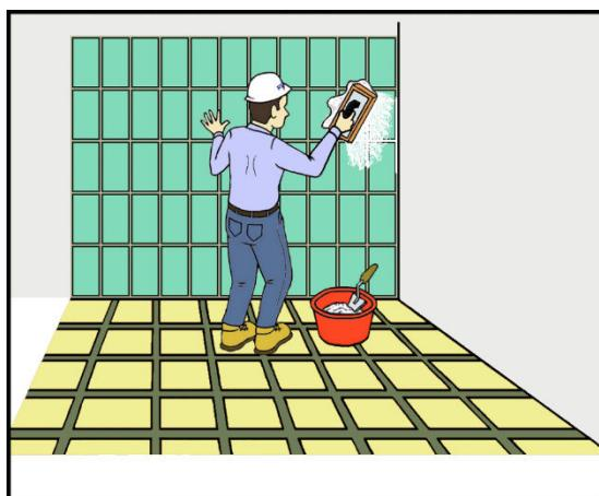
Si queda mezcla sin usar mientras se aplica una porción, vuelva a mezclar cada 10 minutos de dejar reposar la Junta. Después de aproximadamente 3 horas de haber colocado la Junta, limpie perfectamente los excedentes del emboquillador con la ayuda de un trapo limpio y seco o una fibra verde para trastes si es necesario. Espere un mínimo de 36 horas para poder limpiar el polvo y/o directamente lavar con agua.
